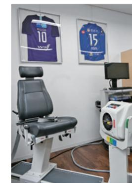
筋機能評価運動装置
